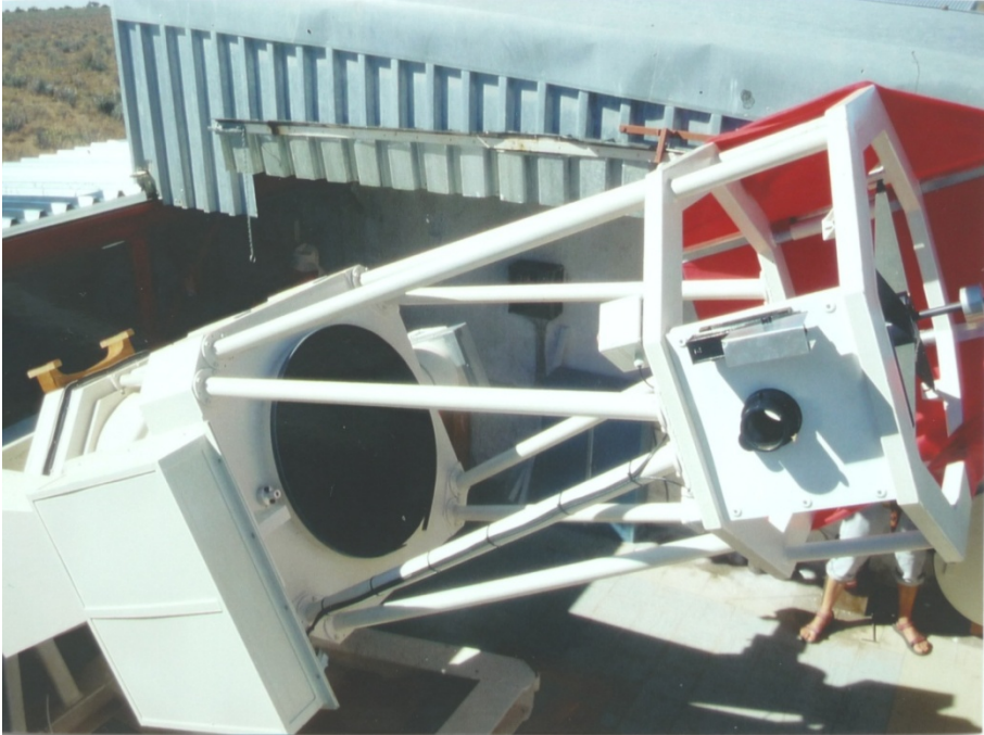
Abb. 4: 71 cm-Newton-Spiegelteleskop auf dem Gamsberg
