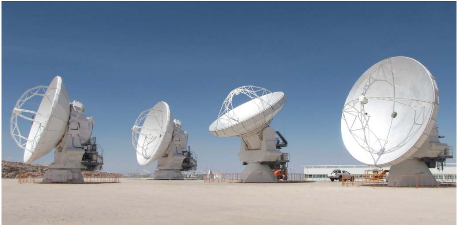
Abb. 5: Projekt ALMA. Vier Submillimeter-Teleskope mit 12 m Spiegeldurchmesser in der Basisstation während der Prüfung
