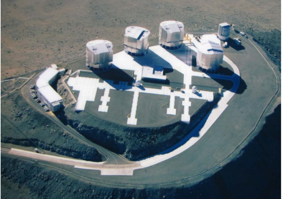
Abb. 6: Cerro Paranal. Luftbild des Bergplateaus mit den Schutzbauten der vier 8,2 m-Spiegelteleskope, des 2,6 m-Weitwinkelteleskops und der vier 1,8 m-Hilfsteleskope, die auf den hellen Bahnen verschoben werden.
