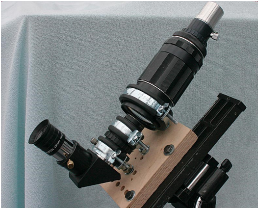
Abb. 8: Kollimator, mit einer höhenverstellbaren Rohrschelle drehbar auf einem stabilen Holzbrettchen montiert
