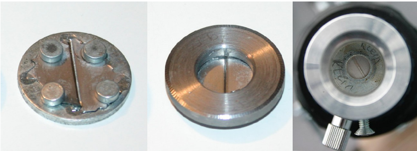
Abb. 7: Der einfache Experimentalspektrograph mit einem selbstgefertigten Spalt
