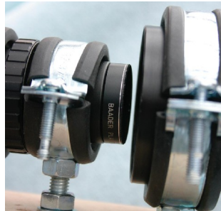
Abb. 8: Kollimator, mit einer höhenverstellbaren Rohrschelle drehbar auf einem stabilen Holzbrettchen montiert
