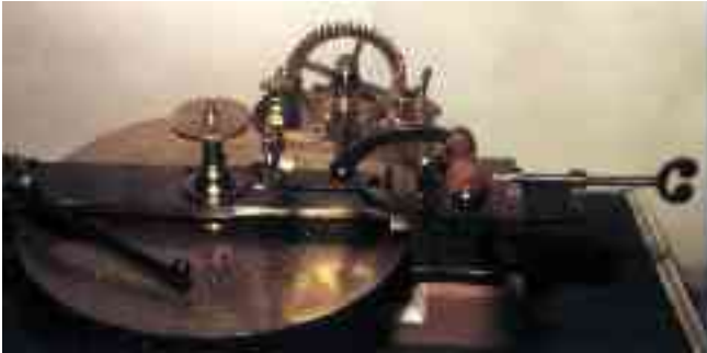
Abb. 2: Zahnrad-Teilmaschine mit aufgespanntem Rohling
