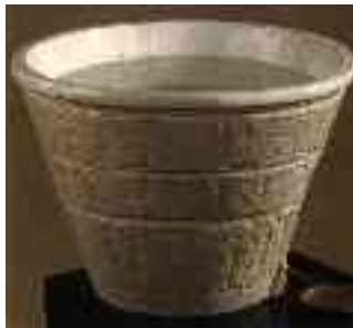
Abb.1: Nachbildung einer ägyptischen Wasserauslauf-Uhr
